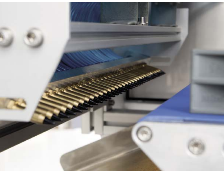
Abb. 1: 32 Hochpräzisionsdüsen katapultieren erkannte NIO-Anteile bei der Nussortierung mit gezielten Luftstößen aus der Flugbahn in einen Ausschussbehälter.
