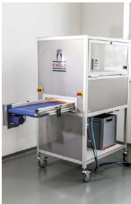
■ Abb. 2: Safe-Ident Sort von Strelen Control Systems ermöglicht die wirtschaftliche Prüfung und Sortierung von Nüssen.
